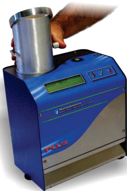
Habiendo pesado y seleccionado el tipo de grano, colocar el vaso Volcador en la parte superior de la Cuba de Medición. Presionar el botón para liberar el grano y éste caerá dentro de la Cuba de Medición en forma pareja.
